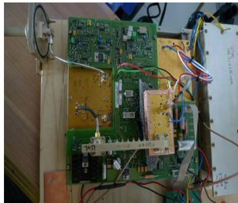
Mikrovågslänk moddad till amatörband
