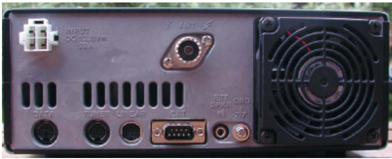
Riggens baksida med tydlig märkning av dom tillgängliga kontakterna till omgivning. Notera den 4-poliga kontakten för spänningsmatningen och CAT-kontakten för kommunikation med en PC.
