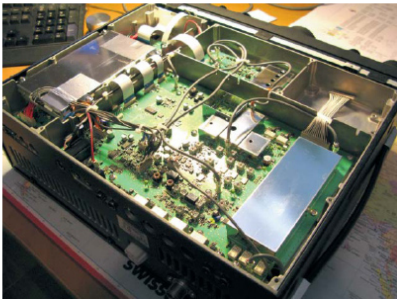
Inuti FT-950 från undersidan. 3 kort, varav det stora är huvudkortet för riggen. Sändare och mottagarkedjan finns här i huvudsak. Uppe i mitten syns VFO:n med sina DDS, PLL och VCO-delar. I plåtlådan nere till höger gömmer sig bandpassfilterna. En hel del kopplingskablar leder signaler kors och tvärs. Ser trots allt prydligt och förtroendeingivande ut. Man noterar tydligt att det inte är trång på korten.
